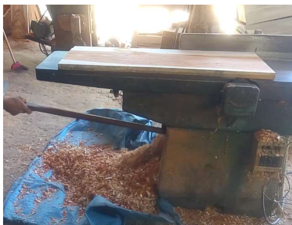
Figura 8. Retirada de resíduo madeireiro do equipamento de forma manual, no município de Laranjal do Jari- AP.
