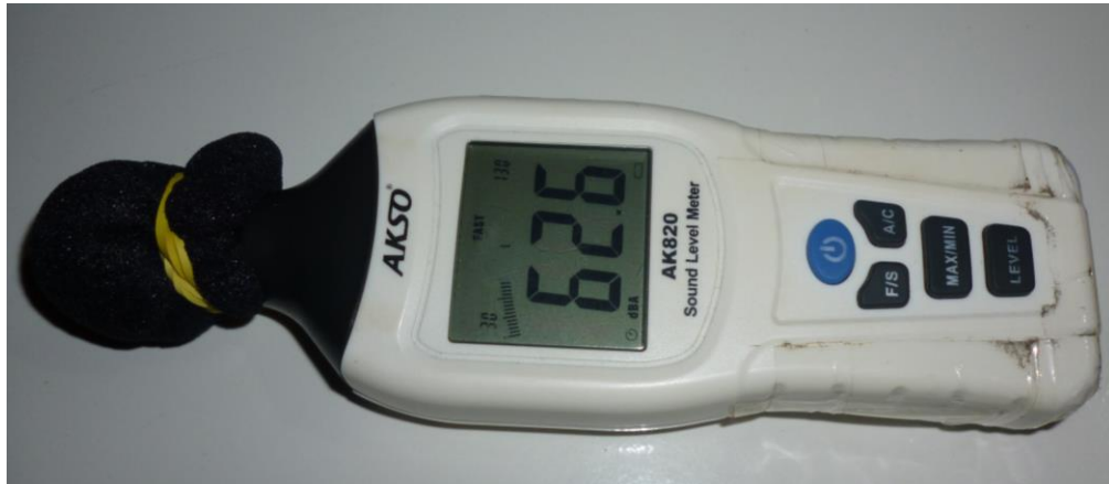
Figura 7 – Aparelho utilizado para medir o nível de pressão sonora (Decibelímetro digital AK820 Akso).
